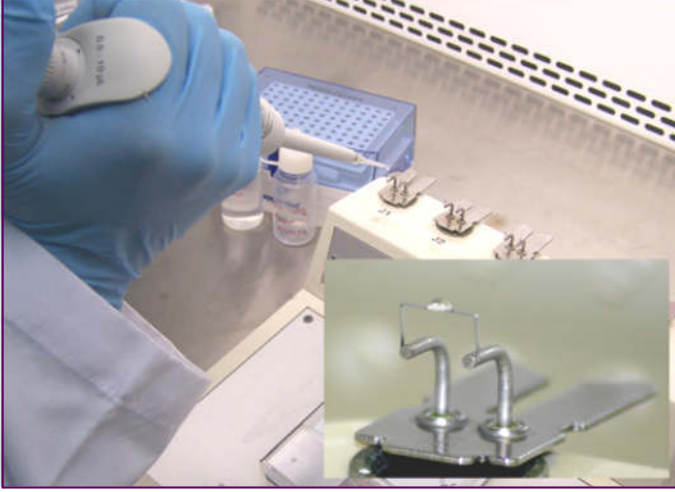
Şekil 3. Numunenin filamente yüklenmesi
