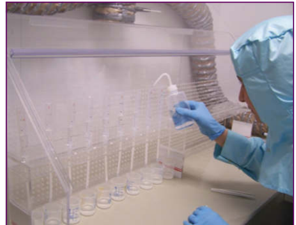
Şekil 2. Neodmiyum kromatografisi çalışması
