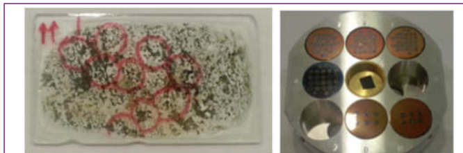
Şekil 2. EPMA'da kullanılan numuneler. a) ince kesit, b) epoksida hazırlanan katı standart bloklar
