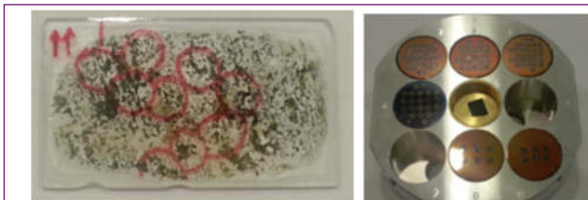
Şekil 2. EPMA'da kullanılan numuneler. a) ince kesit, b) epoksilde hazırlanan katı standart bloklar
